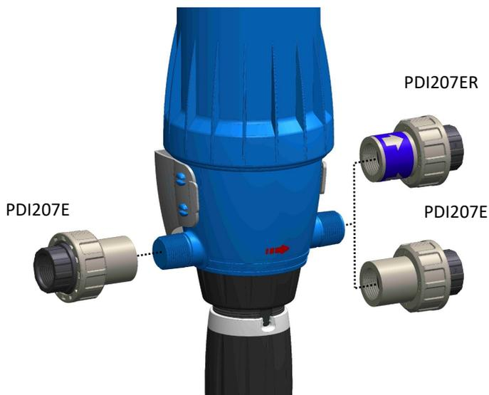
I bocchettoni di montaggio per i miscelatori Dosatron sono ideali per il montaggio su tubazione in acciaio. La guarnizione piana in battuta evita l'uso di sigillanti sul filetto del corpo del dosatore evita il danneggiamento o la rottura del filetto, attutisce le vibrazioni del tubo e garantisce la tenuta idraulica alle condizioni di targa del dosatore.
