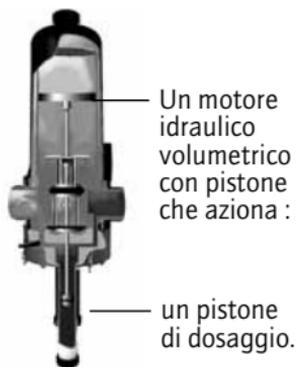
Nel suo movimento di va e vieni, il pistone motore emette i clac :
